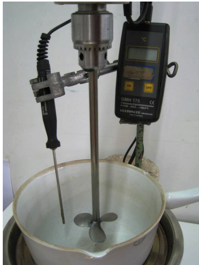
Abbildungen 1 bis 3: Geräte zur Herstellung von Gummi-modifiziertem Bitumen aus Gummi-modifiziertem Bitumengranulat und Straßenbaubitumen im Laboratorium
